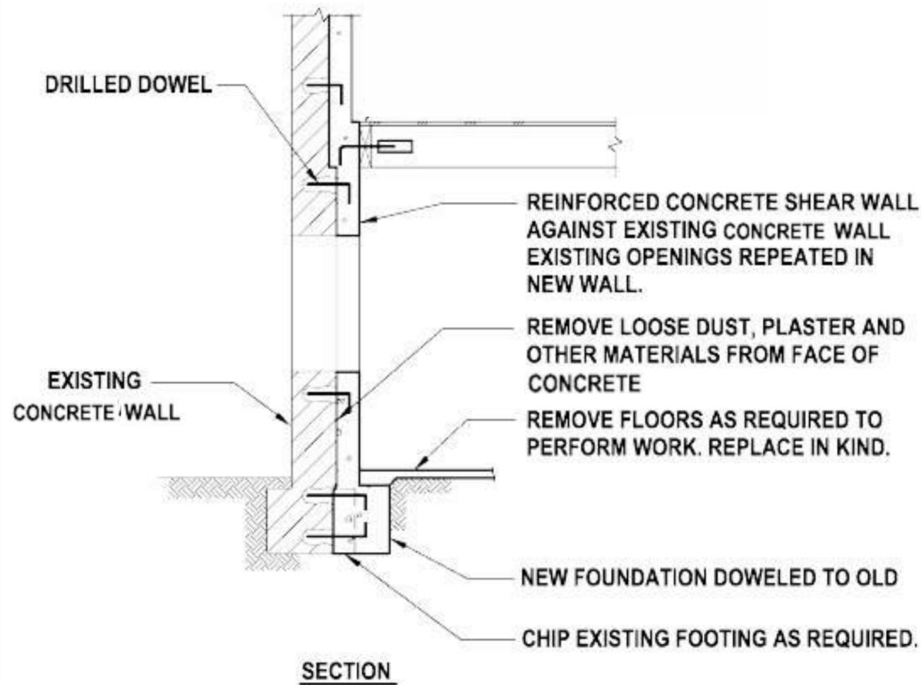
**Figure 21.4.5-1: Concrete or Shotcrete Wall Overlay**
